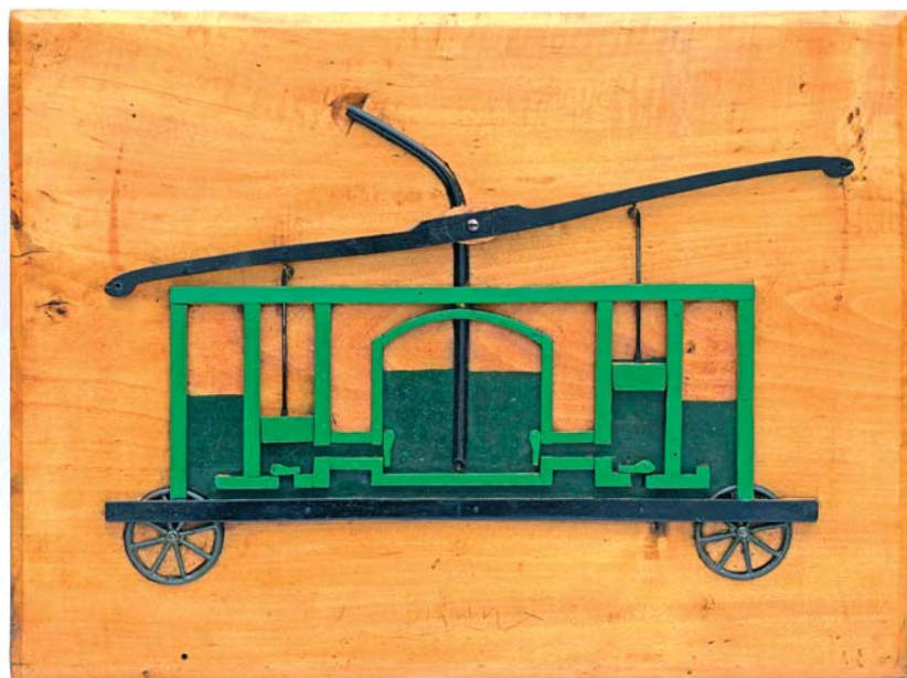
Obr. 12: Reliévní obrázek – průřez hasičské stříkačky; Technické muzeum v Brně; foto: Eva Řezáčová.
